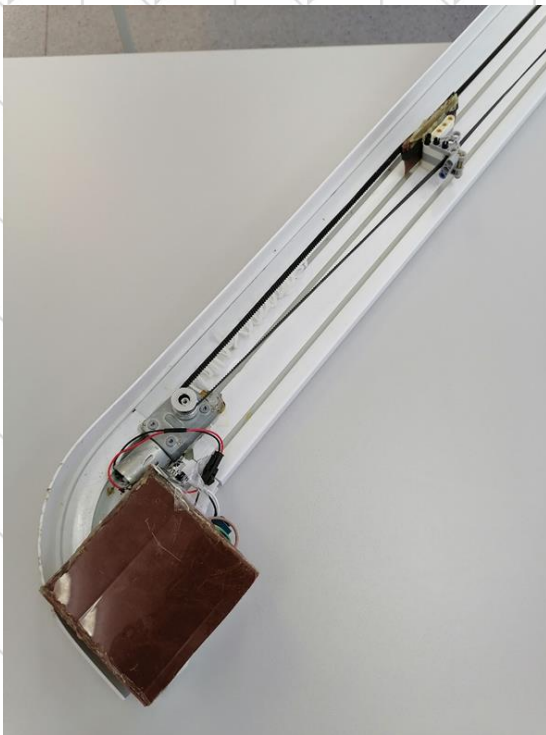
МБОУ Пышминского ГО «Ощепковская средняя общеобразовательная школа». Конструктор Амперка Руководитель - Гришко Константин Евгеньевич. Модель: Автоматизированное устройство для открытия и закрытия штор. Егоров Тимофей (10 класс) Модель: «Счётчик отжимания», Безбородов Егор (10 класс)
