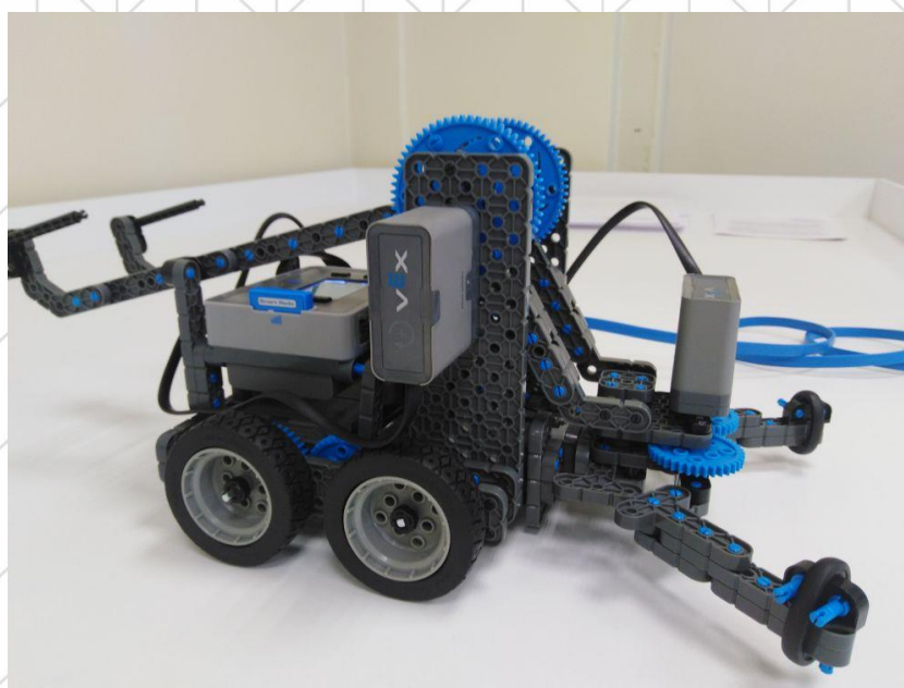
МКОУ СОШ д. Васькино, Нижнесергинский МР Саматов Самир, Аминов Радмир (7 кл), Блинова Зарина (6 класс) Руководитель - Динеева Диля Данифовна Конструктор VEX IQ. Модель: «Робот Clawbot IQ»
